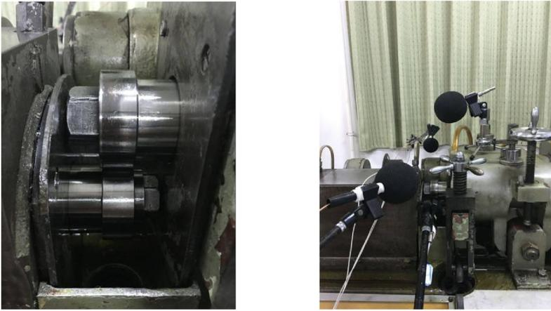
图 2 试件安装及传声器布置
