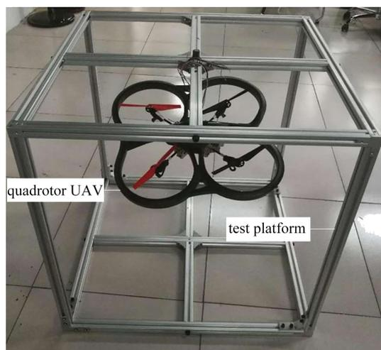
图4 四旋翼无人机实验台架
