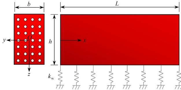
图 1 Winkler 弹性地基上多孔 2D-FGM 微梁几何尺寸及坐标系
