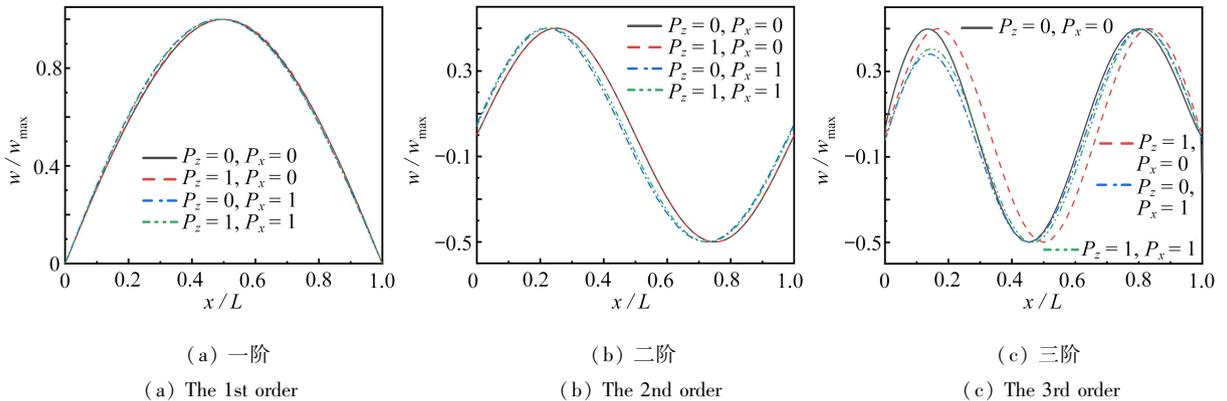
图 8 弹性地基上多孔 2D-FGM 微梁的前三阶振动模态 (S-S 边界)
