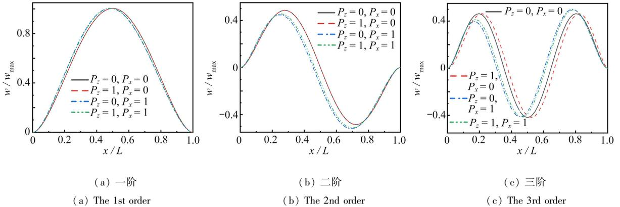
图 7 弹性地基上多孔 2D-FGM 微梁的前三阶振动模态 (C-C 边界)
