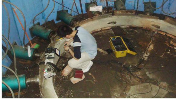
图 3 井壁结构受力模拟实验
