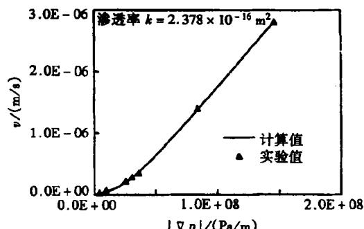
图2 低渗透介质非线性渗流定律模型
