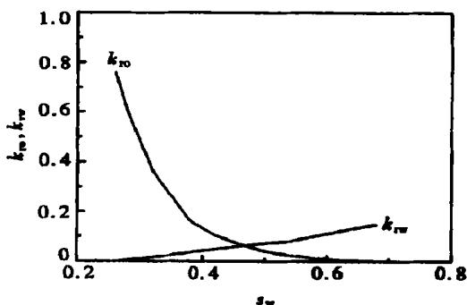
图 5 油水相对渗透率曲线
