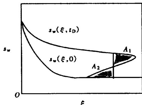
图 8 含水饱和度突变界面示意图
