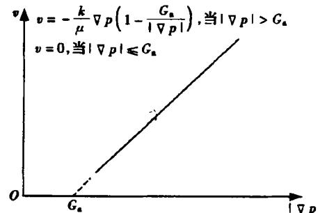
图4 具启动压力梯度模型描述的渗流曲线
