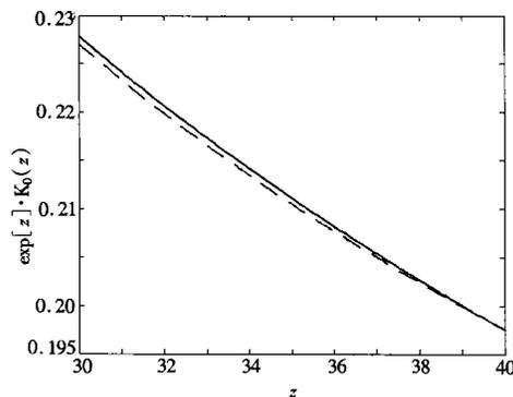
图 4 指数变换方法和 D. E. Amos<sup>[1]</sup> 的计算结果
