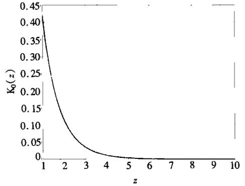
图 1 零阶第二类变型 Bessel 函数  $K_0(z)$  与  $z$  的关系<sup>[1]</sup> ( $1 \leq z \leq +\infty$ )
